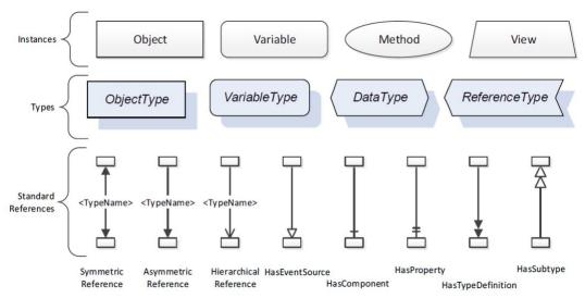
Figure\_Apx 8: The OPC UA Information Model Notation (OPC UA Part 100, Fig. 3)
